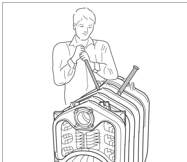
27. attēls Noņem katla bloku
